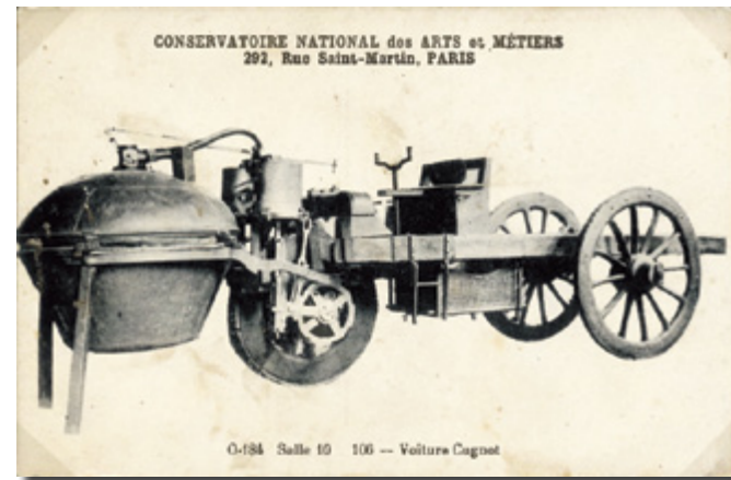
▲ Nicolas Joseph Cugnot, né à Void (Lorraine) le 25/2/ 1725 et décédé à Paris le 7/10/1804. Le premier véhicule à vapeur a été construit par l'officier d'artillerie français N.J. Cugnot (1769) sur l'ordre de Louis XV : il était destiné à tirer les canons et avait une capacité de charge de 4 tonnes.
